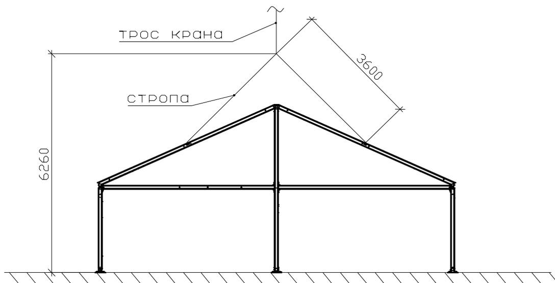
5. Поднять соседнюю арку. Скрепить арки балками обвязки стены, вставив кронштейны обвязки в соответствующие скобы стропил (рис. 4), проем перекрестить тросами L=4740 мм.
