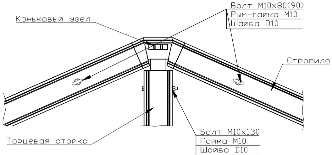
Рым-гайки устанавливаются на одной торцевой, а также на соседней промежуточной фермах друг напротив друга. На остальных фермах используются гайки M10.
