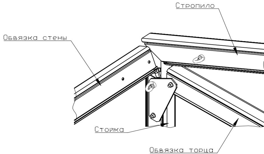
6. С помощью вышки установить прогоны крыши. Крепление прогонов аналогично креплению обвязок стен.
